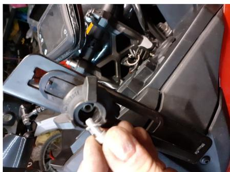
Dépose de la bulle et de son support, Après avoir retirer le petit cache bouton de réglage de la bulle on peut dévisser la vis de blocage, La retirer ainsi que le bouton la bulle peut être retirée, prenez soin de l'ordre des pièces,
