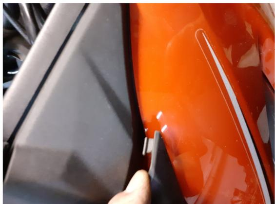
Retirer la vis sur chaque carénage de coté et le retirer en tirant dessus, il tient avec des tétons
